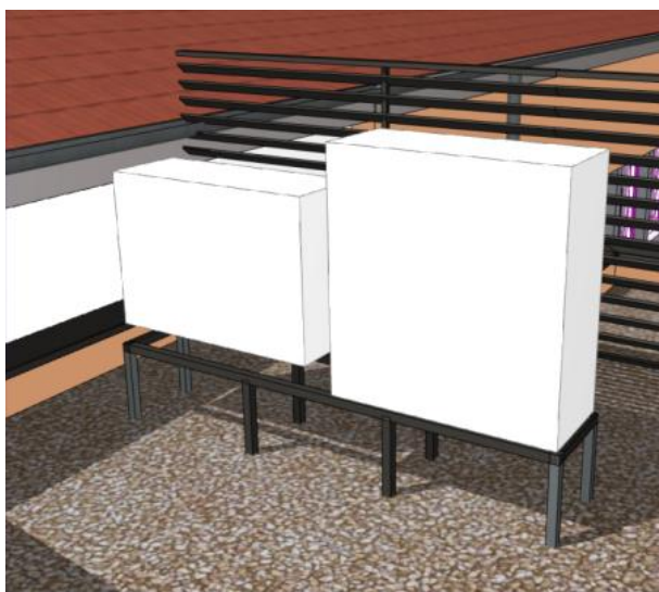
Principe support Onduleur et Groupe clim
